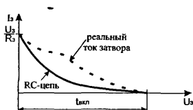
Рис. 5.10. Сравнительные характеристики заряда RC-цепочки и входной емкости затвора полевого транзистора
