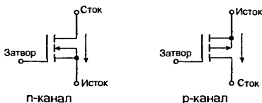
Рис. 5.1. Условное обозначение транзисторов MOSFET
