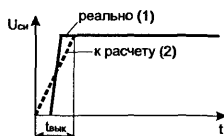
Рис. 5.21. К расчету потерь переключения при работе на активную нагрузку
