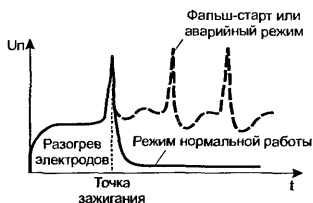
Рис. 15.2. График, поясняющий режимы работы лампы дневного света
